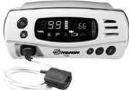
**Pulsioxímetro portátil de sonda NONIN 7500***Portable pulse oximeter probe NONIN 7500*
