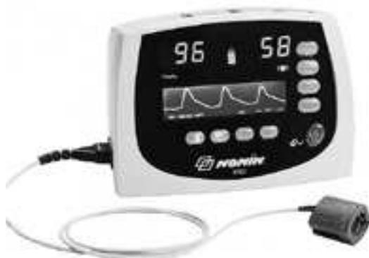
**Monitor de pulsioximetría portátil NONIN Avant 9700 con onda plestimográfica***Nonin Avant 9700 portable pulse oximeter with plethysmographic wave*
